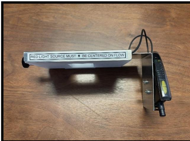
Afloje la perilla del lado izquierdo de la Ventana de Recuento y retire la ventana y el sensor como una sola pieza. NO separe los cables de fibra óptica del sensor.
