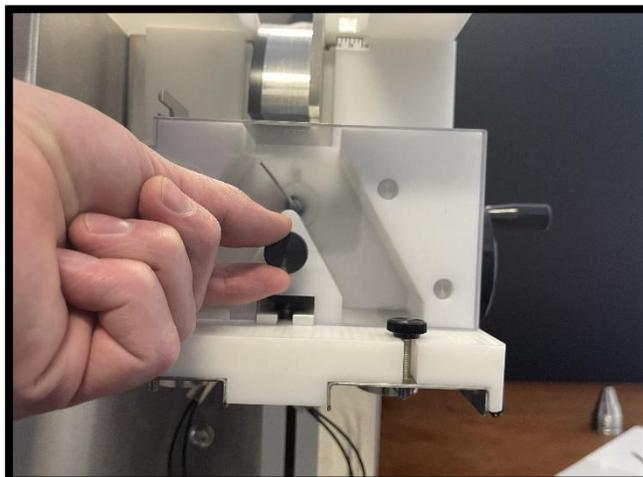
9. Retire la cubierta frontal transparente: desenrosque la perilla y retire la cubierta.
