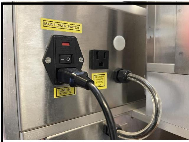
Localice el módulo de entrada de alimentación en la parte trasera de la máquina. Asegúrese de que el interruptor de alimentación principal está en la posición OFF (derecha).
